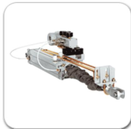
Пневмопривод **АСР301** сочетает в себе силу пневмоцилиндров с возможностями интеллектуального микропроцессорного позиционера и позволяет с максимальной точностью реализовывать функции регулирования и управления. Благодаря модульной структуре, пневматический привод АСР-301 реализован для самых разных размеров цилиндра. Пневмоцилиндрический привод выпускается в нескольких модификациях, в зависимости от требуемого функционала и длины перемещения. При этом существует 2 основных модели:
