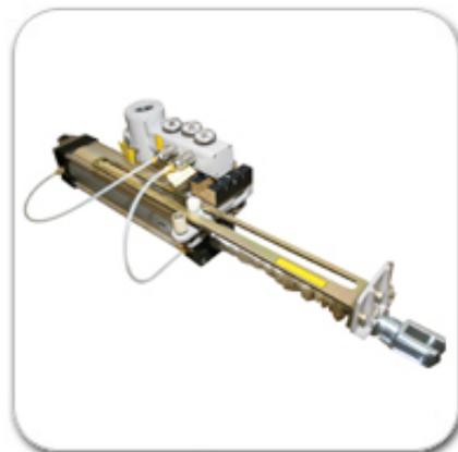
Пневмопривод **ACP303** сочетает в себе силу пневмоцилиндров с возможностями интеллектуального микропроцессорного позиционера и позволяет с максимальной точностью реализовывать функции регулирования и управления. Благодаря модульной структуре, **пневматический привод ACP-303** реализован для самых разных размеров цилиндра. Пневмоцилиндрический привод выпускается в нескольких модификациях, в зависимости от требуемого функционала и длины перемещения. При этом существует 2 основных модели:
