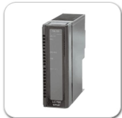
**FB-700** устанавливается в контроллер **LC700** . Настройка модуля и контроллера может осуществляться с помощью программного обеспечения **CONF700** и **SYSCON** .
