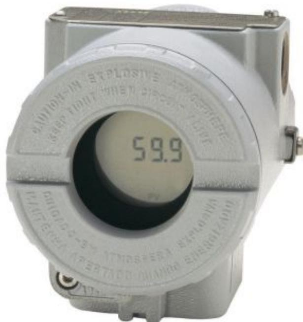
Преобразователь аналогового сигнала [IF302](#) преобразует распространенные сигналы 4-20 мА и 0-20 мА в современный цифровой протокол Foundation Fieldbus с целью интеграции полевого устройства в систему контроля. В конвертере [IF302](#) используются современные цифровые технологии, одно устройство одновременно обрабатывает три аналоговых входных сигнала и является отличным решением для создания АСУТП с минимальными затратами на покупку полевого оборудования.
