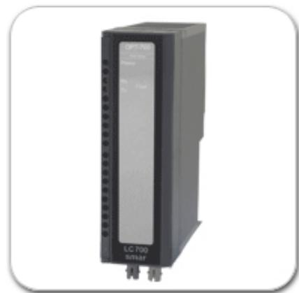
Оптический промышленный модем **OPT-700** поддерживает большой ряд скоростей передач данных, используемых в последовательных интерфейсах. RS-232 может работать на скоростях от 2400 до 115.2 кбит/с, для сети RS485 доступны скорости от 2400 до 920 кбит/с.
