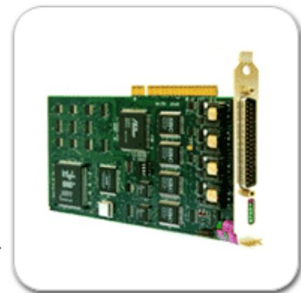
Благодаря **PCI302**, для работы с полевыми устройствами Foundation Fieldbus, достаточно наличие персонального компьютера и соответствующего программного обеспечения.
