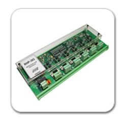
получателя. **Репитер RHP303**выполняет свою функцию в обоих направлениях. Кроме того, устройство обеспечивает гальваническую развязку между сегментами цифровой промышленной сети. Таким образом, RHP303 повышает работоспособность сети, фильтруя электромагнитные помехи и исключает, что какой-либо из проблемных сегментов сети дает наводки на главный канал.
