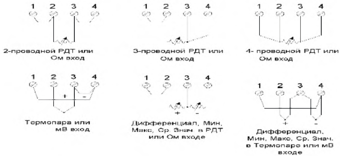
Рис 2. Примеры подключения температурных сенсоров к ТТ421.
